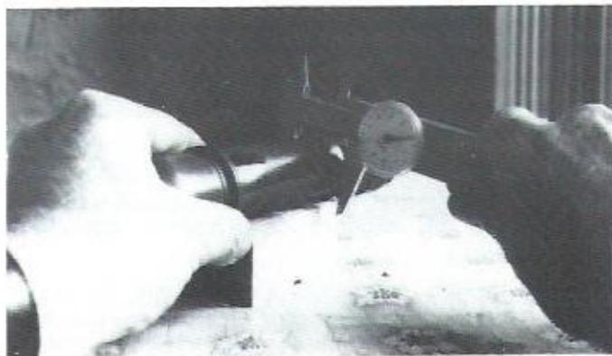
Fig. 2. Utilisation du pied à coulisse pour mesurer l'extérieur de l'instrument.
