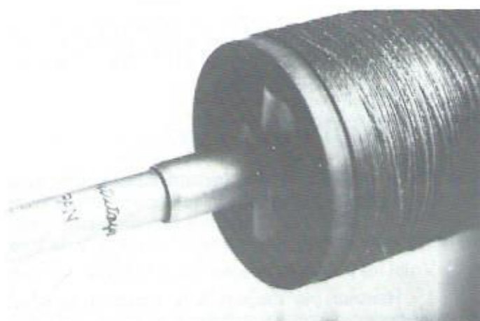
Fig. 3. Mesure de la perce à l'aide d'une jauge télescopique insérée dans l'instrument.
